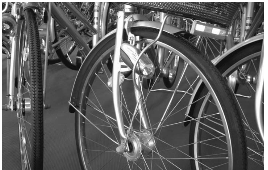
車輪の中心の発電機が回転しライトが自動で点灯する
