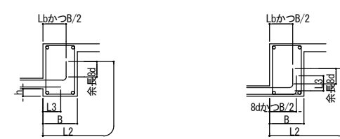
図10-3-1 スラブが梁側面に付く場合
