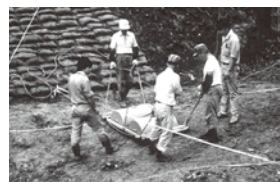
▲地下レーダーを使い地下の様子を探る
