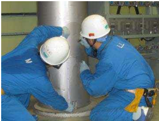
汚染状況の調査 (線量率測定箇所のマーキング【完了】、 現在、データ取りまとめ中)
