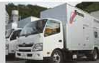
高圧発電機車
