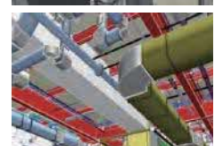
隠ぺい部の確認（BIMの活用）
