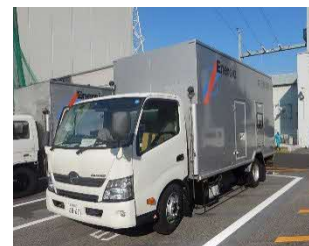
高圧発電機車
