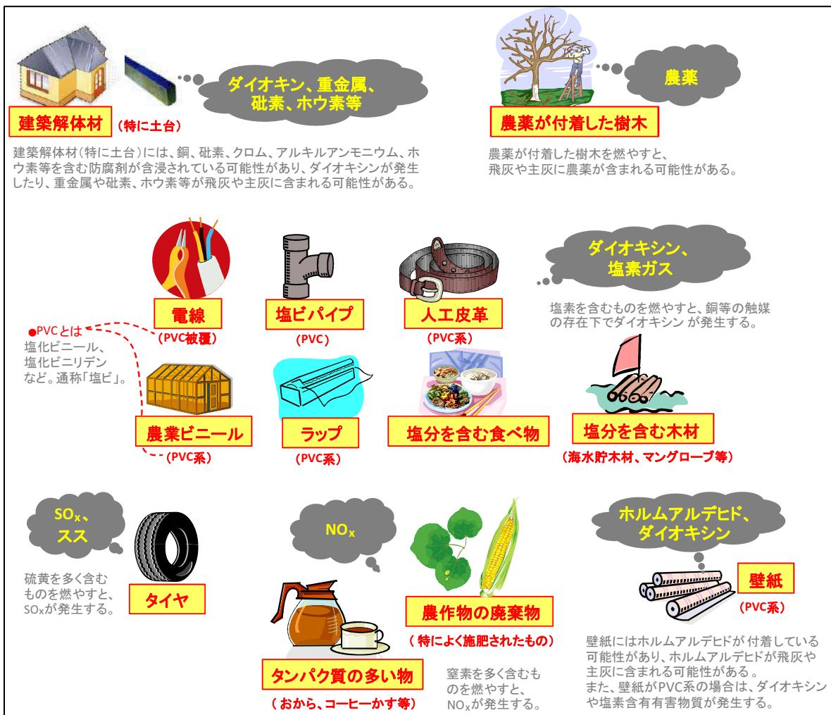
図3-1 木質バイオマスストーブで燃焼させてはいけないもの（例）
