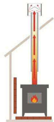
図 5-8　煙突設置の推奨例
