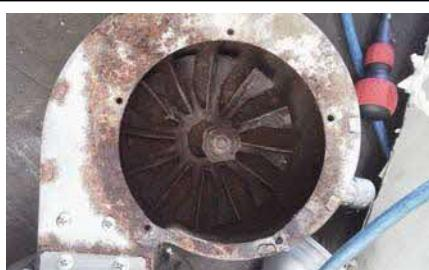
【状況】平成 22 年 10 月設置のストーブで、使用中に排気ファンより異音があり回収確認したところ、通常では起こり得ない程度のサビが発生し、腐食によりフィンが脱落した。
