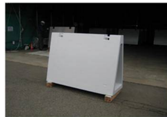
車両の進入を防止 するためのブロック （東海発電所で使用）
