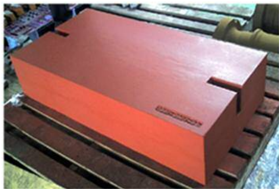
遮へい体 （J-PARC*で使用） ※大強度陽子加速器施設
