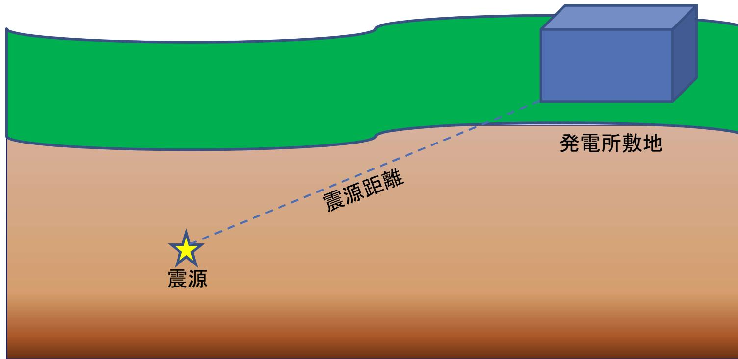
応答スペクトルを用いた手法による地震動評価の概念図
