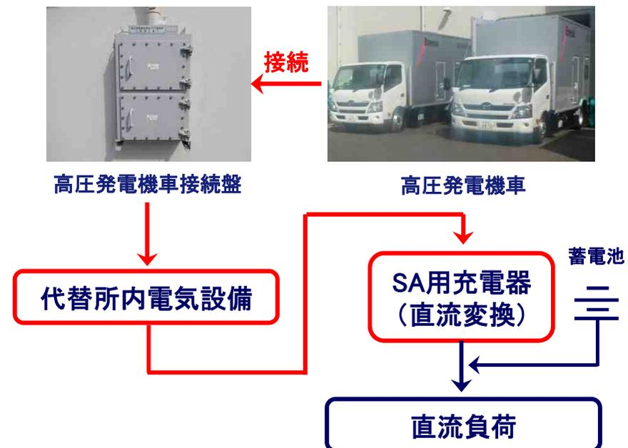
(注) 可搬型直流電源設備として、高圧発電機車と組み合わせて使用する直流給電車を自主対策設備として配備する。
