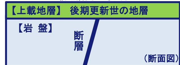
図の例では、上載地層にずれがないことから、断層は、後期更新世以降に活動していないと評価できる。
