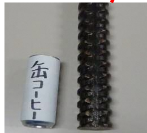
原子炉建物の基礎等で使用している鉄筋（直径51mm）
