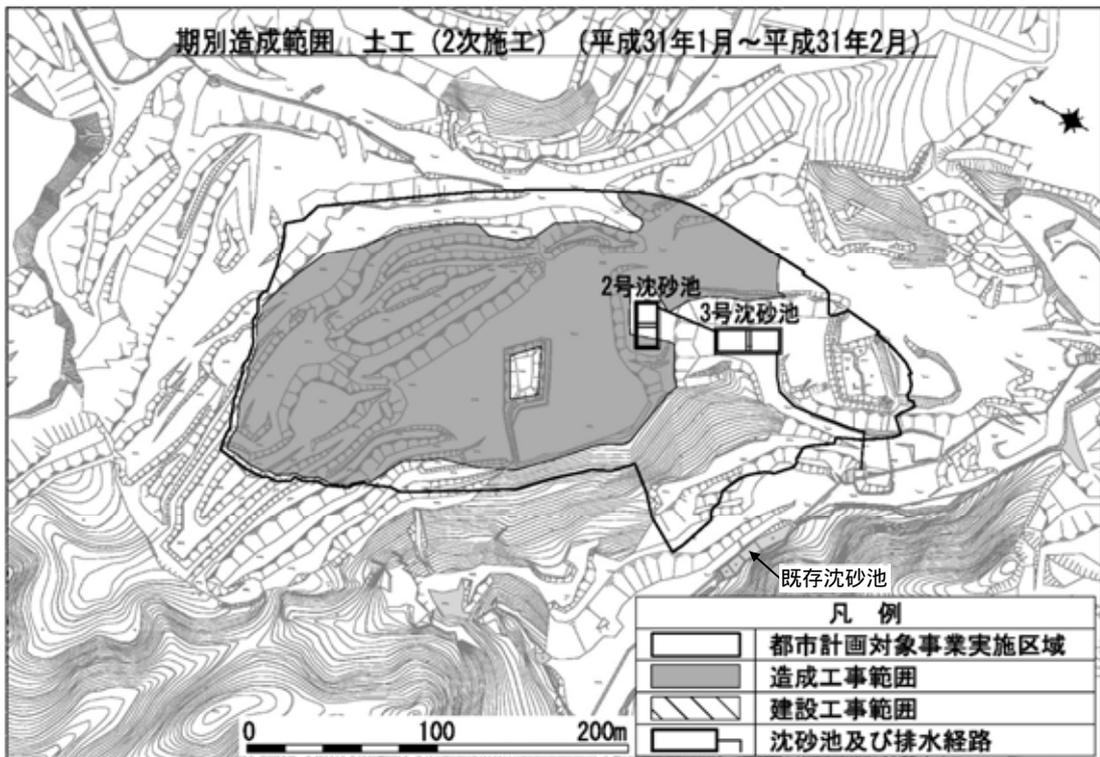
图 2.3-2 施工範圍（土工：2次施工）
