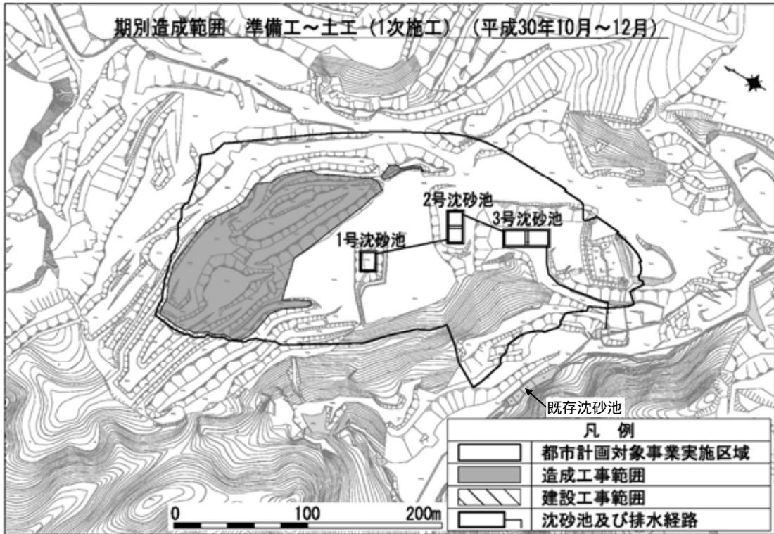
图 2.3-1 施工範圍（準備工～土工：1次施工）
