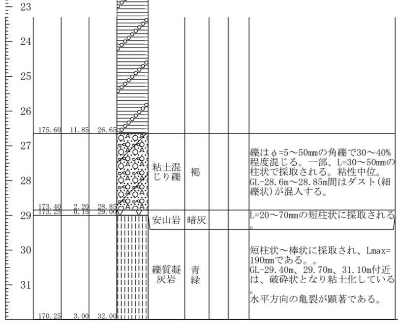
礫はφ=5~50mmの角礫で30~40%程度混じる。一部、l=30~50mmの柱状で採取される。粘性中位。GL-28.6m~28.85m間はダスト(細礫状)が混入する。
