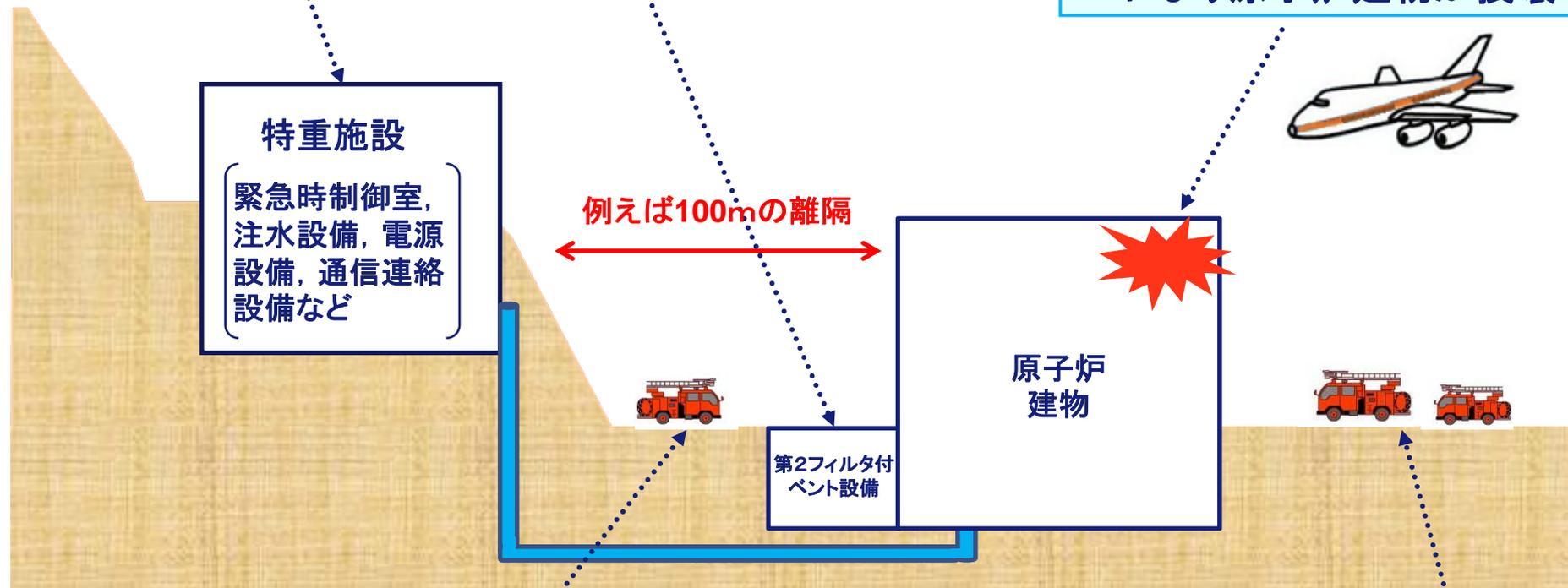
② 送水車等の可搬型設備(重大事故等対処設備)にて原子炉格納容器を冷却
