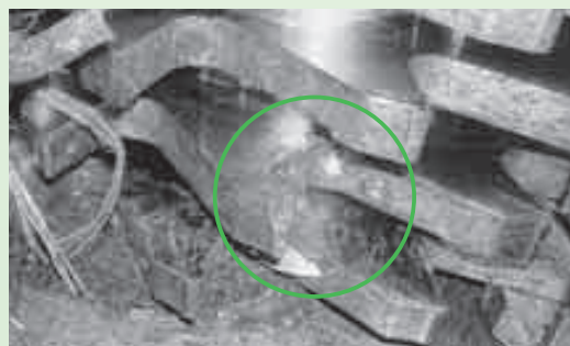
紛れ込んだ金属の塊のために、欠けてしまった破砕機の刃
