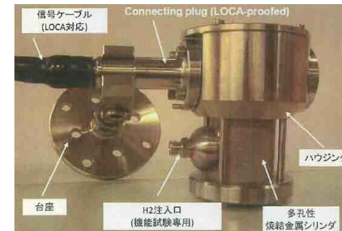
■ : 原子炉建物内水素濃度計
