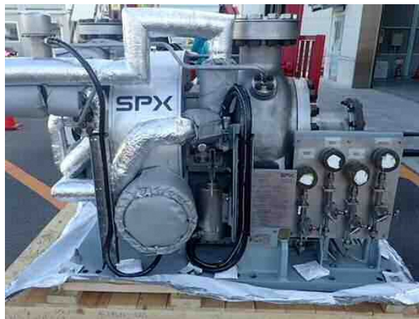
高圧原子炉代替注水ポンプ
